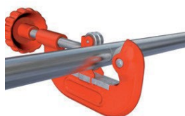
1. Corte de tubo 1. Cortar o tubo
