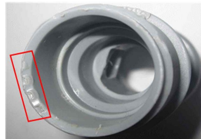
El anillo de retención ha causado daños al cuerpo del racor PB.
