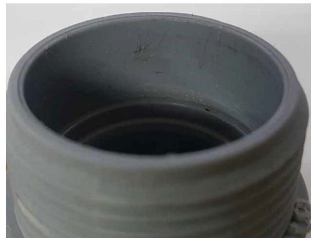
Fuga debido a daños en el cuerpo de PB y las piezas del conjunto de juntade estanquidad causados por la excentricidad en el anillo de retención durante el desbloqueo y el reensamblaje de la tuerca.
