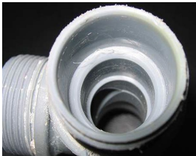
Fuga debido a daños en el cuerpo de PB y las piezas del conjunto de juntade estanquidad causados por la excentricidad en el anillo de retención durante el desbloqueo y el reensamblaje de la tuerca.
