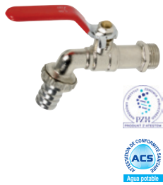
696 - Latón niquelado Con palanca de acero rojo - PS: 16 bar - TS: 0° C/+60 °C
