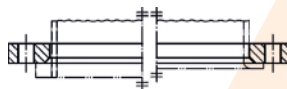
Tipo 02 Brida plana loca con collarín plano para soldar (véase tipo 23) o tubería con extremo con junta de solape (véase tipo 33)
