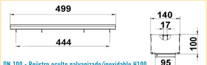
DN 100 - Rejistro oculto galvanizado/inoxidable H100
