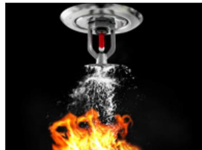
Rociadores automáticos que se apliquen en tuberías y accesorios REPOLEN FIRE RP sólo son aptos y autorizados para la instalación de sistemas húmedos y, serán diseñados para redes ramificadas, aguas abajo del puesto de control y no debiendo disponer de válvulas de corte o elementos que impidan el flujo. UNE EN 12845.
