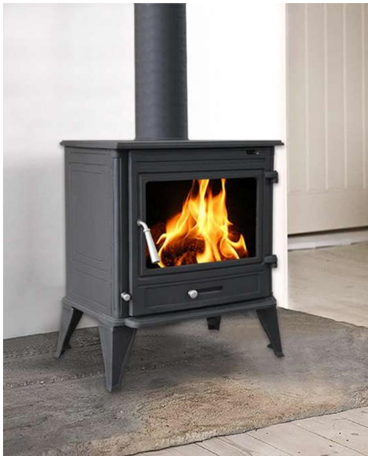
A salamandra a lenha 10kW em com uma potência de 10kW é uma solução para aquecer uma divisão da sua habitação. A estrutura é fabricada em **ferro fundido**. Com um vidro Neocerâmico de 4mm de espessura e com uma amplitude térmica até 900°C. Na pintura é utilizada tinta especializada para equipamentos de temperatura elevada até 650°C. Todas as peças inerentes ao aparelho são em aço.
