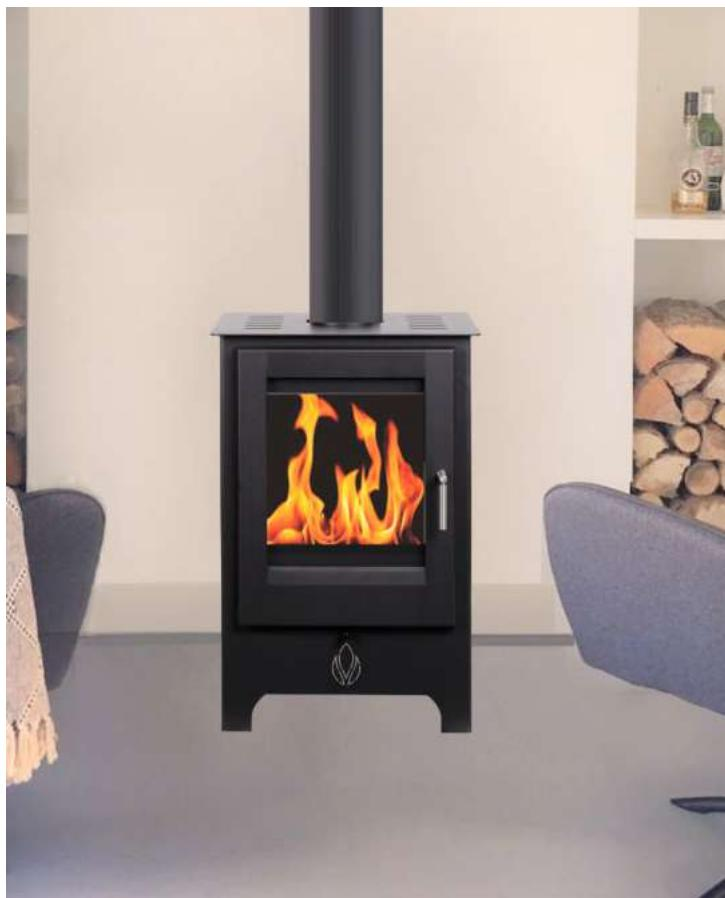
A salamandra a lenha Vitória S com uma potência de 5,5kW é uma solução para aquecer uma divisão da sua habitação. A estrutura é fabricada em chapa de 4mm. A câmara de combustão é revestida com tijolo refratário de alta densidade. Com um vidro Neocerâmico de 4mm de espessura e com uma amplitude térmica até 900°C. Na pintura é utilizada tinta especializada para equipamentos de temperatura elevada até 650°C. Todas as peças inerentes ao aparelho são em aço.
