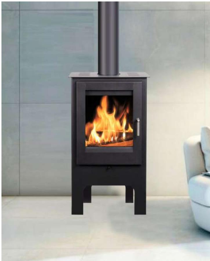
A salamandra a lenha Vitória L com uma potência de 5,5kW é uma solução para aquecer uma divisão da sua habitação. A estrutura é fabricada em chapa de 4mm. A câmara de combustão é revestida com tijolo refratário de alta densidade. Com um vidro Neocerâmico de 4mm de espessura e com uma amplitude térmica até 900°C. Na pintura é utilizada tinta especializada para equipamentos de temperatura elevada até 650°C. Todas as peças inerentes ao aparelho são em aço.
