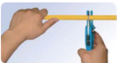
1.- Corte de tubo 1.- Cortar o tubo
