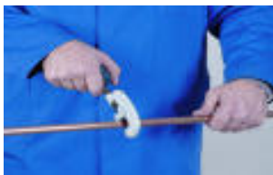
1.- Corte de tubo 1.- Cortar o tubo
