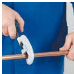
1. Corte de tubo 1. Cortar o tubo
