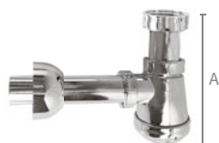
Sifón corto extensible cromado, salida horizontal con racor, alargadera 180 mm. y plafón cromado. Encolable
