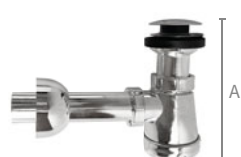
Sifón corto extensible cromado, salida horizontal con válvula Click-Clack, alargadera 180 mm. y plafón cromado
