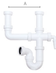
Sifón curvo sin registro lateral extensible salida horizontal con doble racor y toma de electrodomésticos (tuercas locas)
