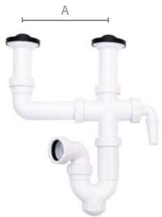
Sifón curvo lateral extensible salida horizontal con doble válvula y toma de electrodomésticos. Chapa Ø70 mm.
