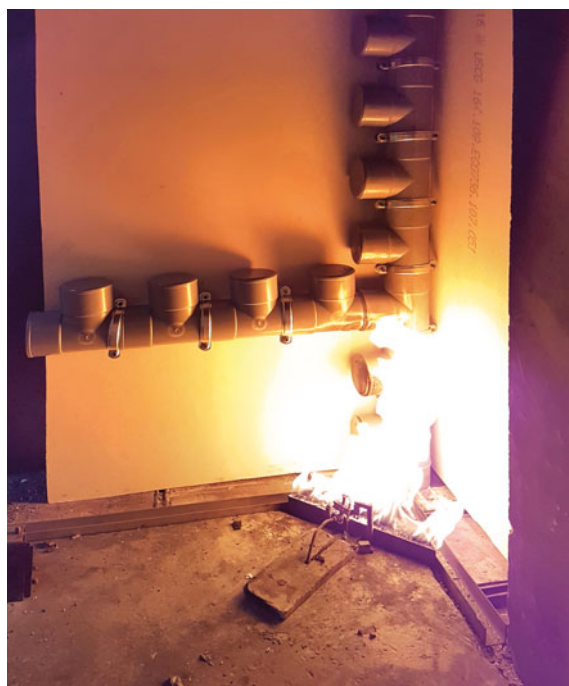
Ensayo SBI (Single Burning Item)
