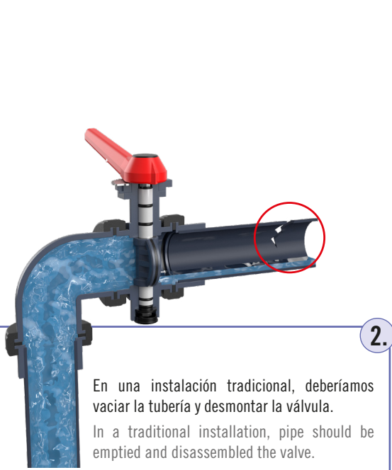
1. Se produce rotura de tubería en una instalación. In case of broken pipe.
