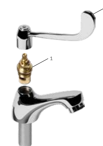
1 Montura cerámica G 1/2" x M 24 Ceramic disc cartridge G 1/2" x M 24 REF. 6870 · PVP: 12,05 €
