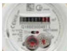
Detalle del totalizador Factores K habituales K=1.
