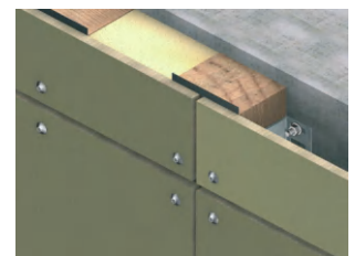
Fibrocemento sobre madera.
