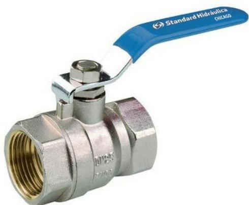
La válvula de esfera Chicago está diseñada y garantizada para el uso en instalaciones de agua potable, agua caliente y redes de aire comprimido. Para combustibles, disolventes, ácidos y líquidos agresivos, consultar.
