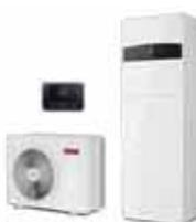
Bomba de calor aire/agua reversible split de alto rendimiento y dimensiones compactas con gas ecológico R32. Unidad interior de instalación sobre suelo con depósito de ACS de 180 litros, filtro magnético y de partículas, vaso de expansión de 12 litros, resistencias eléctricas de apoyo y espacio para colocar vaso de expansión para depósito ACS opcional. Incluye SENSYS NET HD y sonda externa. Tecnología split: con manipulación de gas refrigerante. Conectividad ARISTON NET incluida de serie.
